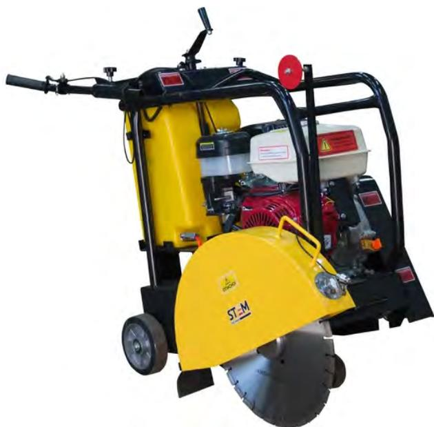
Шовнарезчик STEM Techno SC 452 (STEM GX420) ШОВ032 обеспечивает прямой рез за счет дополнительного направляющего колеса. Простая конструкция с возможностью подачи воды позволяет резать бетон с минимальным количеством пыли.
