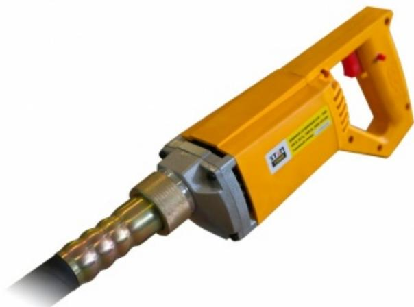
Глубинный вибратор SVE 1000 применяются для распределения и уплотнения бетона и смесей при строительстве. Глубинный вибратор создает колебания, в результате которых из смеси выходит воздух, и бетон заполняет все доступное пространство.
