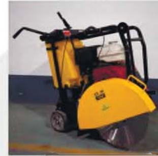
Двигатель с воздушным охлаждением, 4-тактный, одноцилиндровый
