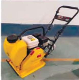
Двигатель с воздушным охлаждением, 4-тактный, одноцилиндровый
