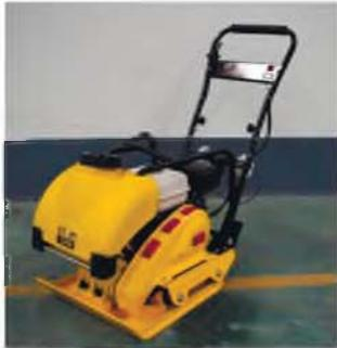
Двигатель с воздушным охлаждением, 4-тактный, одноцилиндровый
